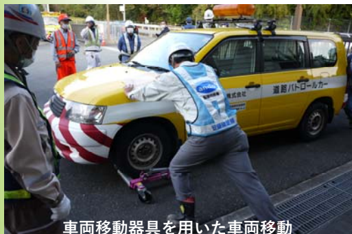
車両移動器具を用いた車両移動
