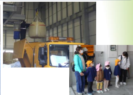
クレーンによる凍結防止剤の積み込み
