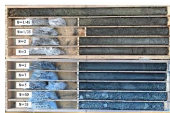
軟弱地盤のボーリングコア
