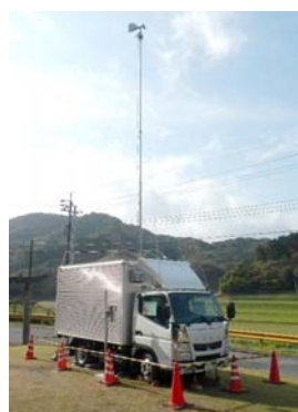
大気測定車の設置 (例)
