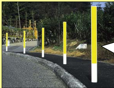
実施事例 (全面反射型視線誘導標)
