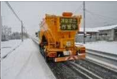
凍結防止剤散布車 ※凍結防止剤を散布する機械
