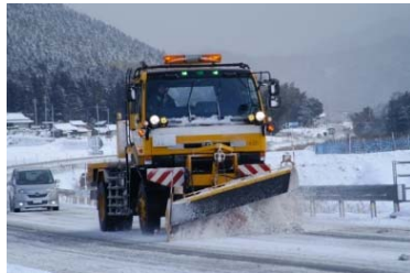
除雪トラックによる除雪作業状況
