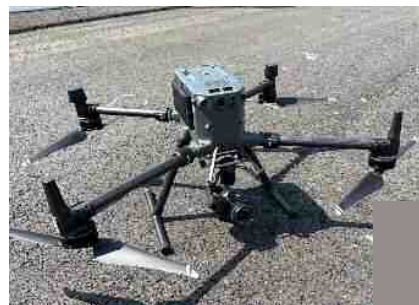
3次元測量機器(ドローン)
