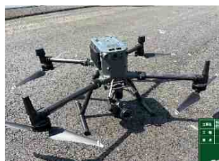
3次元測量機器(ドローン)
