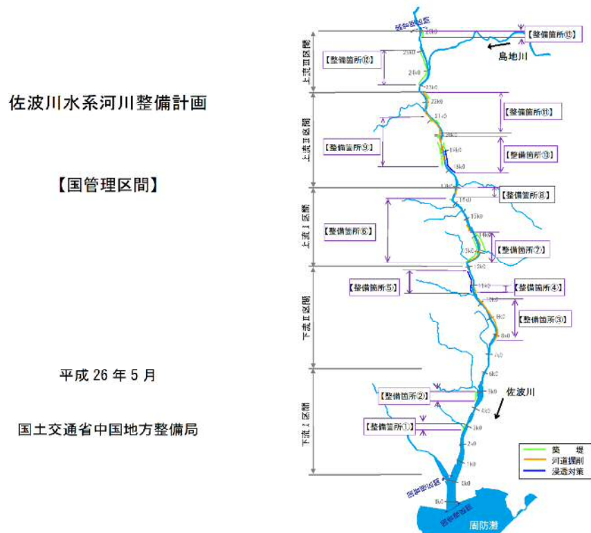
図5.1.2 堤防・河道の整備を実施する箇所
