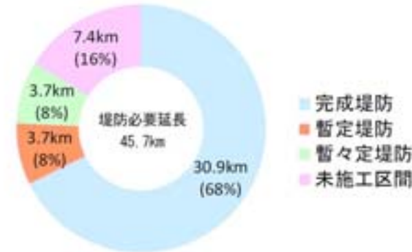
図 3.1.2 堤防の整備状況
