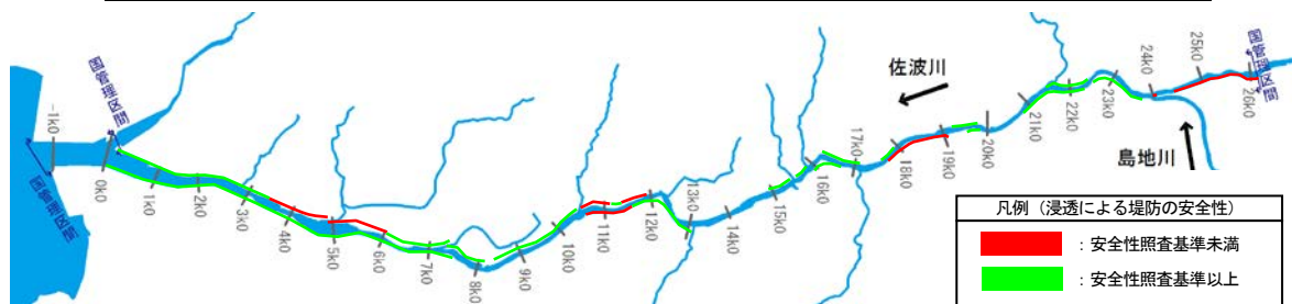
図3.1.3 堤防詳細点検の実施状況
