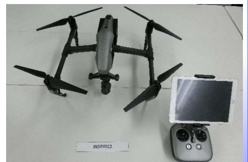
使用されたドローンと操作機器 ドローンの大きさ：約60cm×60cm 重さ：約3.3kg
