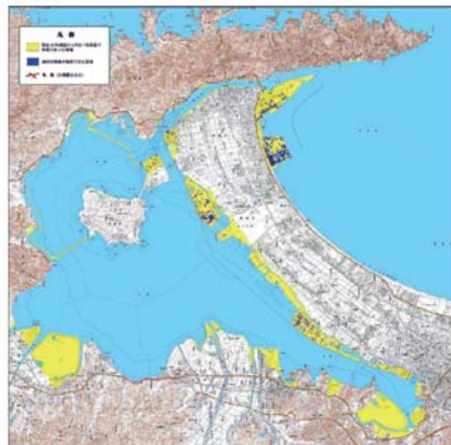
図「平成12年(2000年)鳥取県西部地震」における液状化現象の発生箇所(鳥取県中海周辺) 〔国土地理院ホームページによる〕
